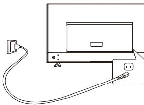
2. 先將電源線與顯示器相連，然後將電源線插頭插到交流電源插座上。（注意：如果電源線已經連接到顯示器，請直接將電源線插頭插到交流電源插座上。）
